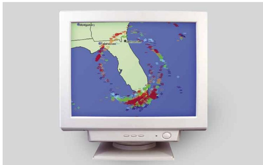
В режиме индикации разряда месторасположения каждой отдельной молнии представляются знаком + или – для идентификации положительной или отрицательной полярности, а также имеют цветовую кодировку в интервалах времени. Размеры маркера могут регулироваться для отображения амплитуды события в килоамперах (кА).
